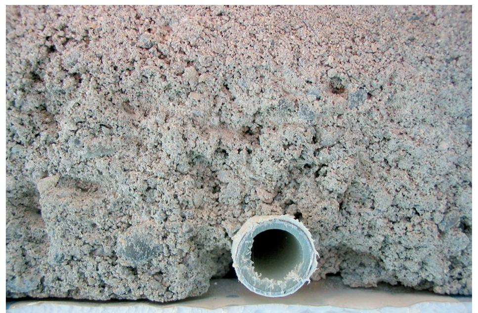
Das Gefüge macht bei der Wärmeübertragung den grossen Unterschied: Links der dichte Aufbau des Calciumsulfat-Fliessestrichs, der das Heizrohr satt umschliesst, rechts der poröse Zementestrich.
