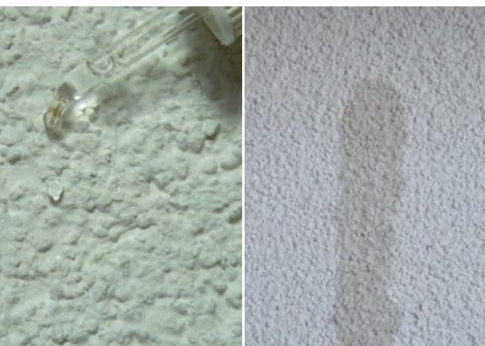
Photo gauche : support non absorbant Photo droite : support absorbant
