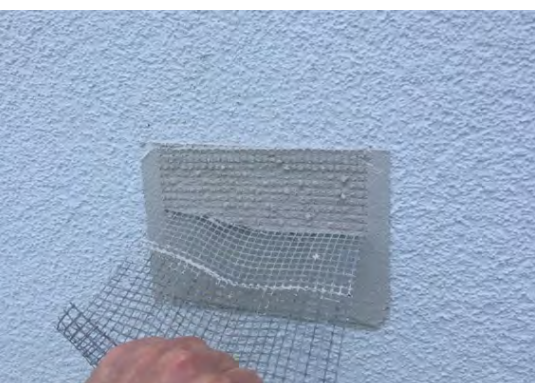
Préparation pour l'essai d'arrachage
