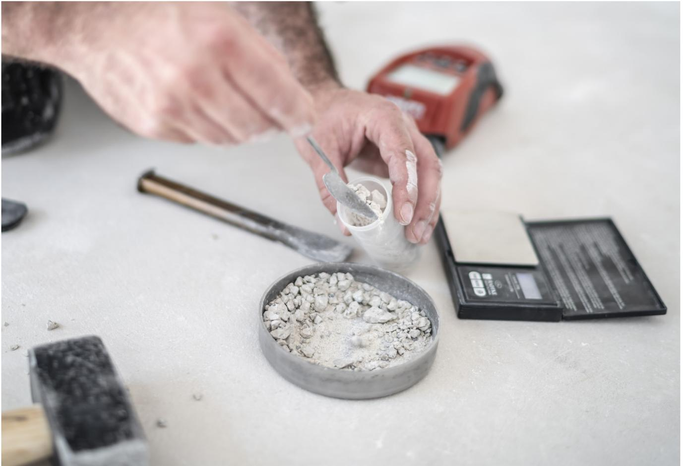
Das Calciumcarbid-Verfahren bzw. Calciumcarbid-Methode (CM-Messung) ist eine schnelle und für viele Fälle ausreichend genaue Feldmethode zur Feuchtemessung. Sie kann dann verwendet werden, wenn ein allseitiger Kontakt des Calciumcarbids mit der Materialprobe hergestellt werden kann.
