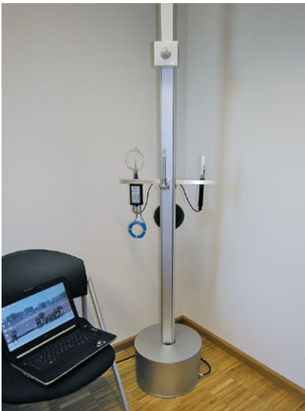
Überprüfung von Lüftungskonzepten durch CO 2 -Messungen
